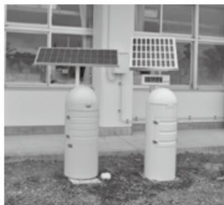
▲熊倉小学校に設置されたリアルタイム線量測定システム
