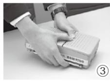
③ 正面に突起している部分を押しながら左側にずらす
