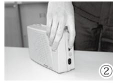
② 受信機の右側面にある電源スイッチを切る
