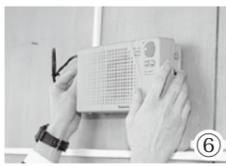
⑥ 元の位置に戻し、アンテナ線、電源コードを接続後、電源を入れる
