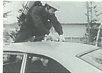
まず屋根の切断 ▶
